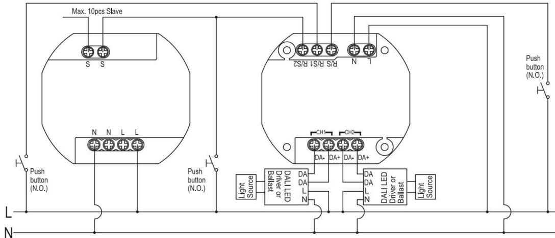
Los terminales de R/S, R/R1, R/S2 pueden controlar el encendido/apagado de la carga de 2 canales manualmente. R/S controla CH1/CH2 dos canales simultáneamente, R/S1 controla el canal CH1, y R/S2 controla el canal CH2.
